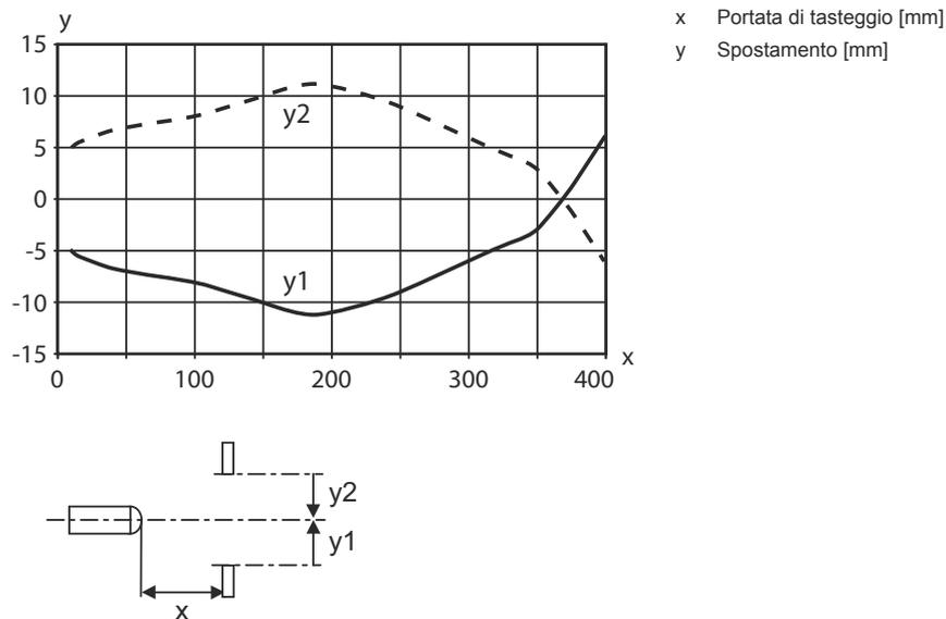
Comportamento di risposta tip. (distanza di regolazione 1200 mm)
