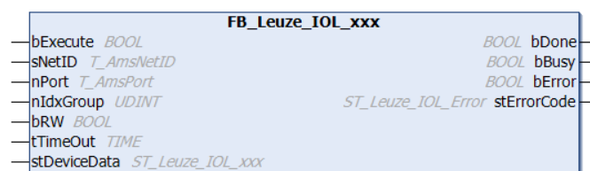
Bild 3.1: Beispiel Bausteinaufruf mit Einzelinstanz
