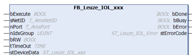
Bild 3.1: Beispiel Bausteinaufruf mit Einzelinstanz
